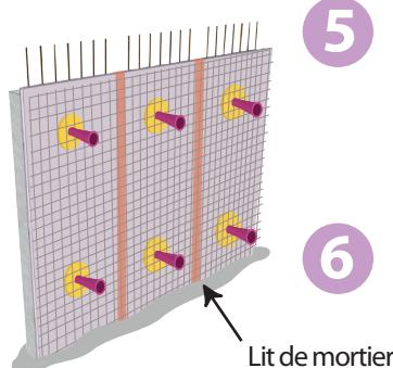
5 Les cônes d'entretoise viennent reposer sur une rondelle de répartition. Les tiges de coffrage et les armatures sont installées.
