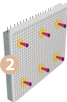
Les cônes d'entretoise viennent reposer sur une rondelle de répartition. Les tiges de coffrage et les armatures sont installées.
