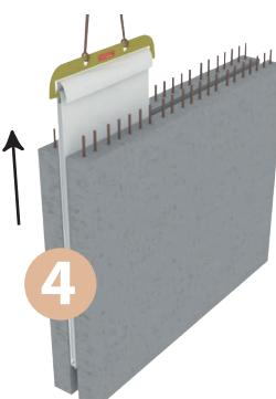
Les SISMO-C® sont retirés à l'aide de l'outil extracteur fourni, laissant un joint de dilatation parfait entre les deux voiles. [respect EUROCODE 8].
