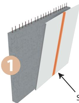
Les panneaux SISMO-C® sont positionnés contre le premier voile. Les tiges filetées traversent le carton.
