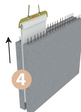
Les SISMO-C® sont retirés à l'aide de l'outil extracteur fourni, laissant un joint de dilatation parfait entre les deux voiles. [respect EUROCODE 8].
