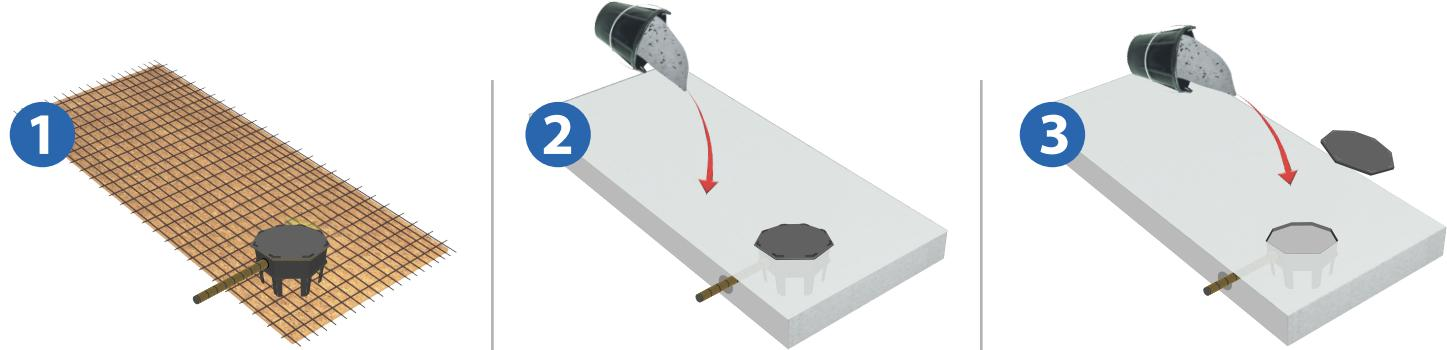
Pose de la RÉZABOITE SIPHON directement sur le treillis soudé (maintien par ligature). Incorporer les fourreaux / gaines.
