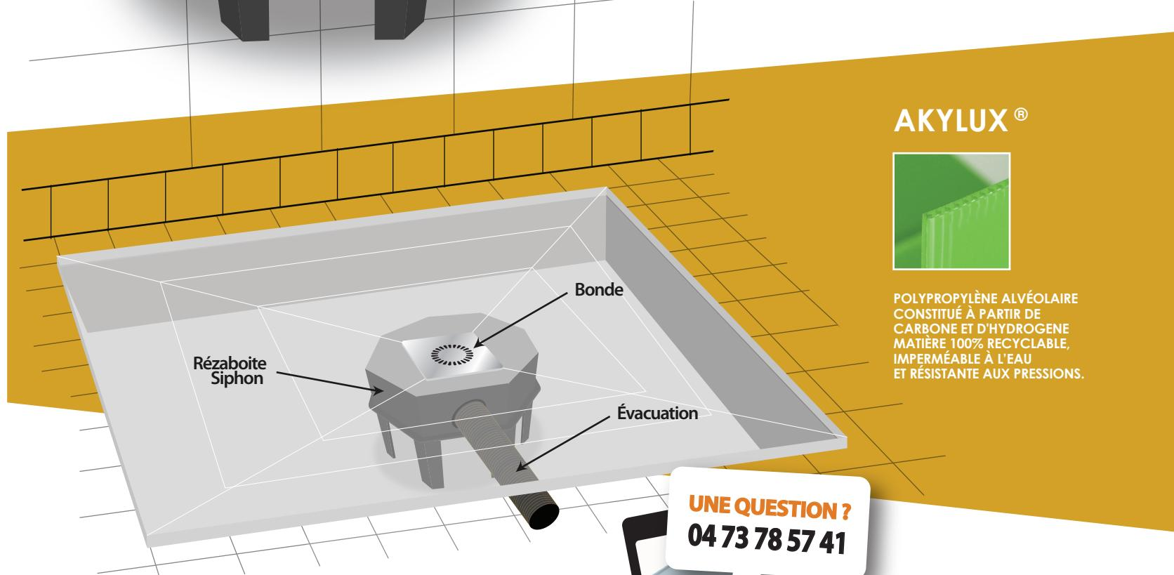
Exemple d'installation d'une douche à l'italienne avec la RÉZABOITE SIPHON pour les PMR.
