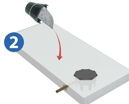
2 Coulage du béton autour de la RÉZABOITE SIPHON
