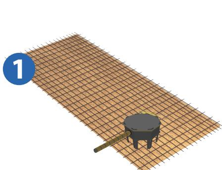
1 Pose de la RÉZABOITE SIPHON directement sur le treillis soudé (maintien par ligature). Incorporer les fourreaux / gaines.
