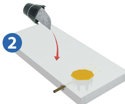
Coulage du béton autour de la RÉZABOITE SIPHON
