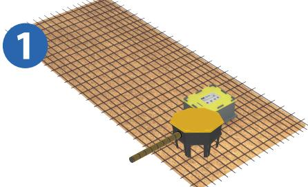
Pose de la RÉZABOITE SIPHON directement sur le treillis soudé (maintien par ligature). Incorporer les fourreaux / gaines.
