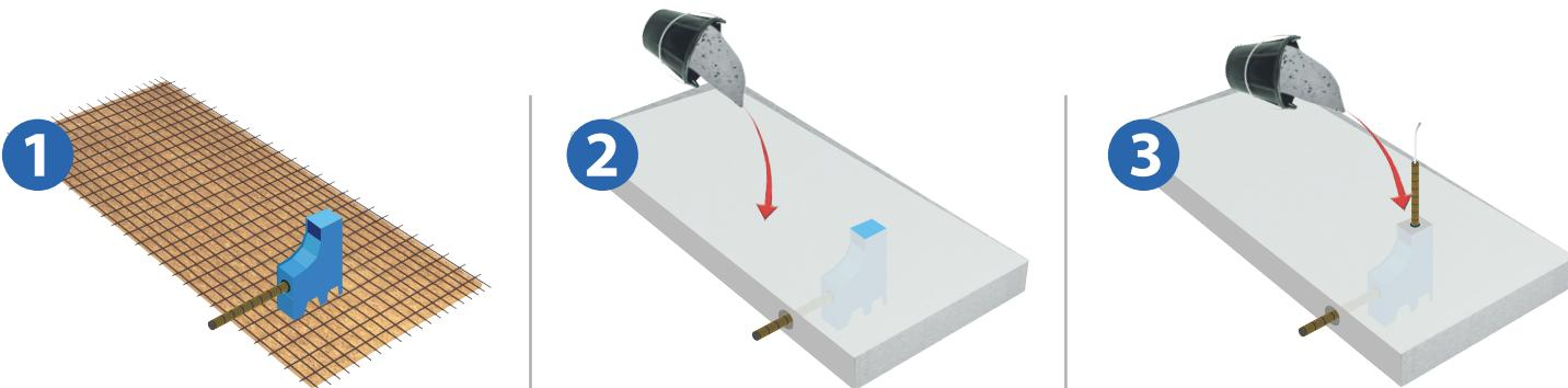
Pose de la RÉZABOITE SABOT directement sur le treillis soudé (maintien par ligature). Incorporer les fourreaux / gaines.
