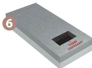
Le fond coffrant est ancré latéralement par le béton pour assurer son maintien.
