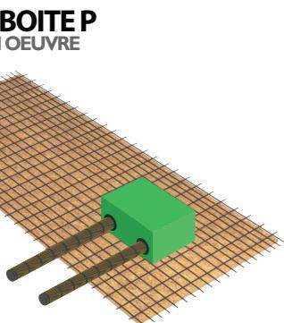
Pose des REZABOITE P directement sur le treillis soudé (maintenu par ligature). Incorporer les fourreaux / gaines.
