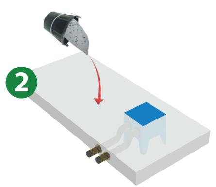
Les pieds de la REZABOITE G sont coupés en fonction de l'épaisseur de dalle. Les REZABOITE G reposent sur le fond de coffrage et sont alors ligaturées au treillis. (En Prédalle : les pieds sont repliés et spittés à l'aide d'un feuillard métallique)
