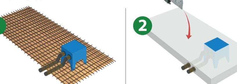
Les pieds de la REZABOITE G sont coupés en fonction de l'épaisseur de dalle. Les REZABOITE G reposent sur le fond de coffrage et sont alors ligaturées au treillis. (En Prédalle : les pieds sont repliés et spittés à l'aide d'un feuillard métallique)
