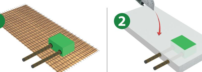
Pose des REZABOITE P directement sur le treillis soudé (maintenu par ligature). Incorporer les fourreaux / gaines.
