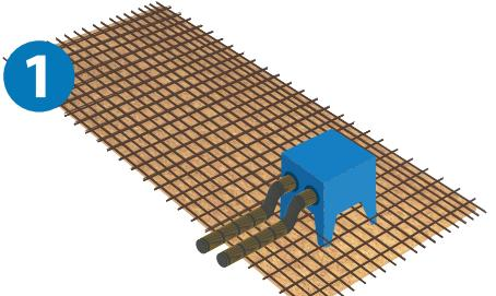
Les pieds de la REZABOITE G sont coupés en fonction de l'épaisseur de dalle. Les REZABOITE G reposent sur le fond de coffrage et sont alors ligaturées au treillis. (En Prédalle : les pieds sont repliés et spittés à l'aide d'un feuilard métallique)
