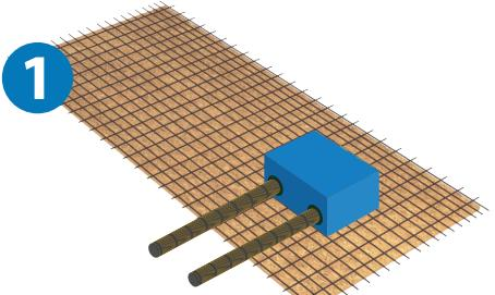
Pose des REZABOITE P directement sur le treillis soudé (maintenu par ligature). Incorporer les fourreaux / gaines.
