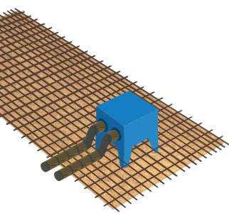
Les pieds de la REZABOITE G sont coupés en fonction de l'épaisseur de dalle. Les REZABOITE G reposent sur le fond de coffrage et sont alors ligaturées au treillis. (En Prédalle : les pieds sont repliés et spittés à l'aide d'un feuillard métallique)
