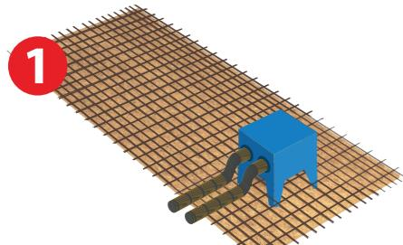
Les pieds de la REZABOITE G sont coupés en fonction de l'épaisseur de dalle. Les REZABOITE G reposent sur le fond de coffrage et sont alors ligaturées au treillis. (En Prédalle : les pieds sont repliés et spittés à l'aide d'un feillard métallique)
