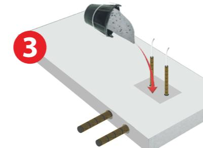
Ouverture de la REZABOITE P. Passage des PE, raccordement au réseau et rebouchage de la réservation
