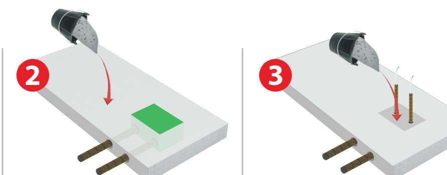
Coulage du béton autour de la REZABOITE P. Les gaines sont protégées
