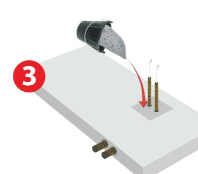
Ouverture de la REZABOITE G. Passage des PE, raccordement au réseau et rebouchage de la réservation
