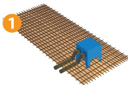
Les pieds de la REZABOITE G sont coupés en fonction de l'épaisseur de dalle. Les REZABOITE G reposent sur le fond de la cofferage et sont alors ligaturées au treillis.
