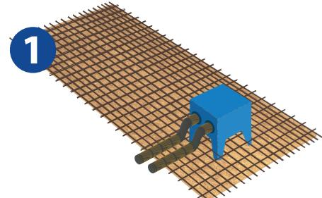
Les pieds de la REZABOITE G sont coupés en fonction de l'épaisseur de dalle. Les REZABOITE G reposent sur le fond de coffrage et sont alors ligaturées au treillis. (En Prédalle : les pieds sont repliés et spittés à l'aide d'un feuillard métallique)
