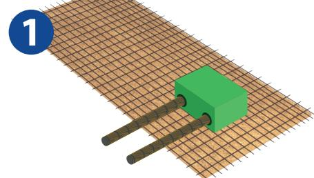
Pose des REZABOITE P directement sur le treillis soudé (maintenu par ligature). Incorporer les fourreaux / gaines.
