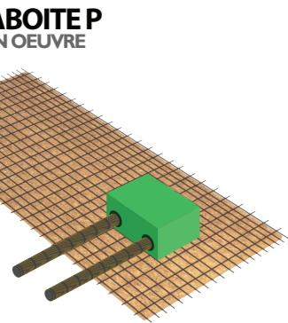
Pose des REZABOITE P directement sur le treillis soudé (maintenu par ligature). Incorporer les fourreaux / gaines.
