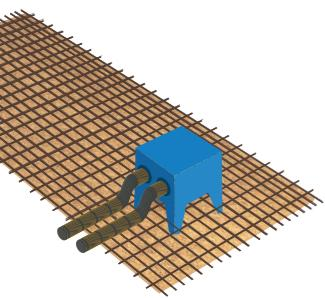
Les pieds de la REZABOITE G sont coupés en fonction de l'épaisseur de dalle. Les REZABOITE G reposent sur le fond de coffrage et sont alors ligaturées au treillis. (En Prédalle : les pieds sont repliés et spittés à l'aide d'un feuillard métallique)
