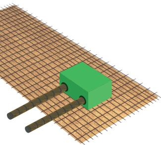
Pose des REZABOITE P directement sur le treillis soudé (maintenu par ligature). Incorporer les fourreaux / gaines.
