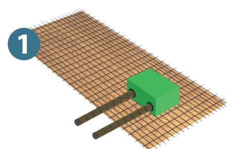
Pose des REZABOITE P directement sur le treillis soudé (maintenu par ligature). Incorporer les fourreaux / gaines.
