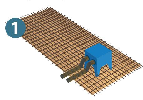
Les pieds de la REZABOITE G sont coupés en fonction de l'épaisseur de dalle. Les REZABOITE G reposent sur le fond de coffrage et sont alors ligaturées au treillis. (En Prédalle : les pieds sont repliés et spittés à l'aide d'un feuillard métallique)
