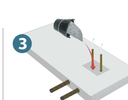
Ouverture de la REZABOITE P. Passage des PE, raccordement au réseau et rebouchage de la réservation.
