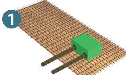
Pose des REZABOITE P directement sur le treillis soudé (maintien par ligature). Incorporer les fourreaux / gaines.
