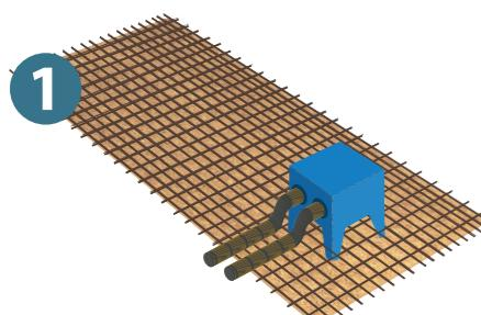
Les pieds de la REZABOITE G sont coupés en fonction de l'épaisseur de dalle. Les REZABOITE G reposent sur le fond de coffrage et sont alors ligaturées au treillis. (En Prédalle : les pieds sont repliés et spittés à l'aide d'un feuillard métallique)
