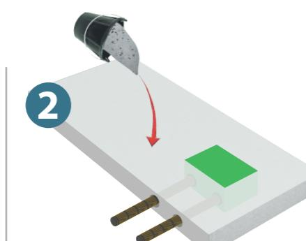
Coulage du béton autour de la REZABOITE P. Les gaines sont protégées.
