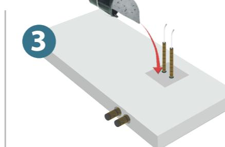
Ouverture de la REZABOITE G. Passage des PE, raccordement au réseau et rebouchage de la réservation.
