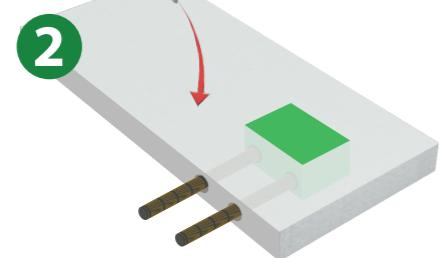
Gießen des Betonum REZABOITE P. Die Hüllrohre werden geschützt.
