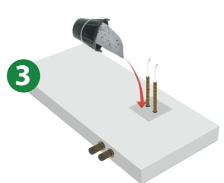
Öffnen der REZABOITE G Durchführen der PE, Anschluss an das Netzwerk und Verschließen der Käst.
