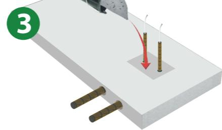
Öffnen der REZABOITE P Durchführen der PE, Anschluss an das Netzwerk und Verschließen der Käst.
