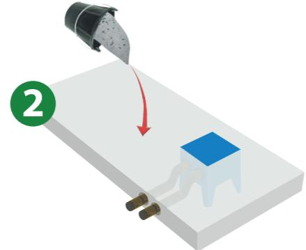
Gießen des Betonum REZABOITE G. Die Hüllrohre werden geschützt.
