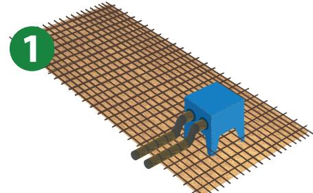
Die Füße der REZABOITE G werden entsprechend der Platten dicke zugeschnitten. Die REZABOITE G liegen auf dem Schalungsboden und werden dann mit dem Gitter verbunden. (Bei der Vorplatte: Die Füße werden umgebogen und mit einem Metallband gespittet).
