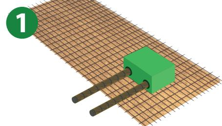
Verlegung von REZABOITE P direkt auf dem Stahlmatte (Halt durch Ligatur). Einarbeiten von Rohrhülsen / installationsschacht.
