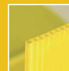
POLYPROPYLÈNE ALVÉOLAIRE CONSTITUÉ À PARTIR DE CARBONE ET D'HYDROGÈNE. MATIÈRE 100% RECYCLABLE, IMPERMÉABLE À L'EAU ET RÉSISTANTE AUX PRESSIONS.
