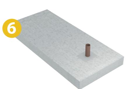
El hueco se tapa directamente sin tener que hacer otro encofrado
