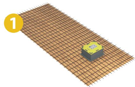
Colocacion de la holobox directamente sobre el fondo de encofrado.
