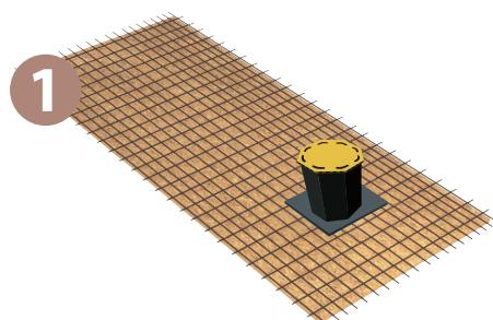
Découpe des armatures à l'emplacement de la réservation. Implantation de la RÉZABOITE CFO sur le fond du coffrage
