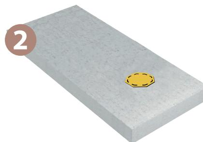
Betonieren rund um den RÉZABOITE CFO.
